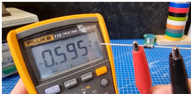
Le branchement est correct, la valeur lue est cohérente = la diode est OK
